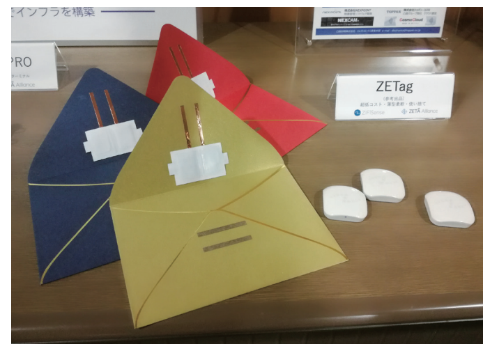
封筒の開閉部に貼り付けられているのが、ZiFiSenseとZinergy UKが開発した「ZETag」。印刷電池技術を使い、非常にローコストな通信モジュールを実現した。封筒の右にあるのは、ZETAでビーコン信号を送信する新デバイス
