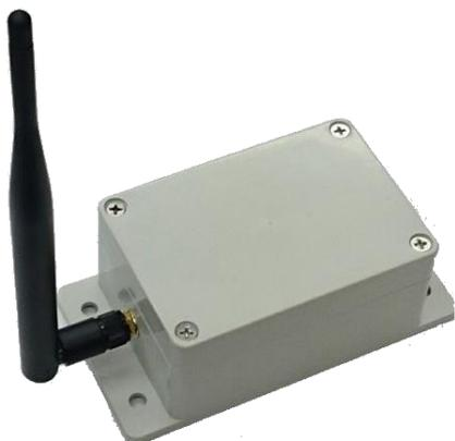
ZETA92JP TEST MS(テストモジュール) は、センサーエッジデバイスの開発用に、ZETA92JP MS(モジュール)、電池ホルダー、アンテナ端子及びシリアル入出力端子を設けた基板をケースに収めたものです。
